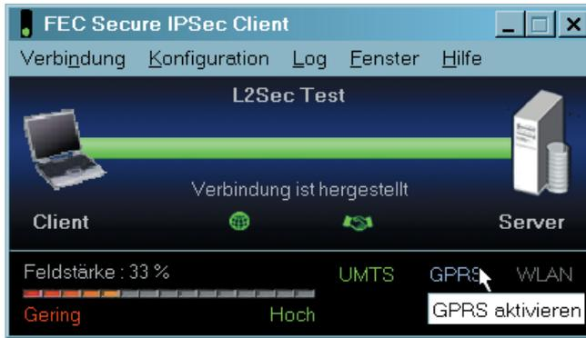
Das Verbindungsmedium kann auch manuell gewechselt werden. Dazu wird mit der Maus das gewünschte Medium angeklickt, im Bild links "GPRS aktivieren".
