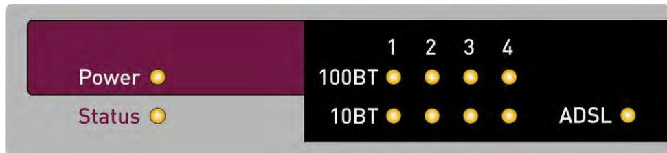
Abb. 3: LEDs von **bintec R230a** / **bintec R230b**
